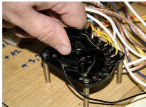
Preklopnik: Mjerenja napona obavljali smo uz pomoć preklopnika koji je bio spojen na jedan voltmetar - tako smo eliminirali potrebu za većim brojem voltmetara.
